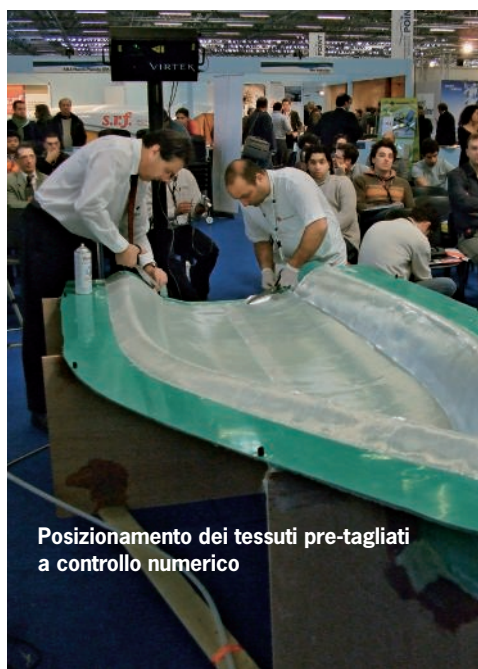
Vestizione degli stampi con ausilio di allineamento laser
